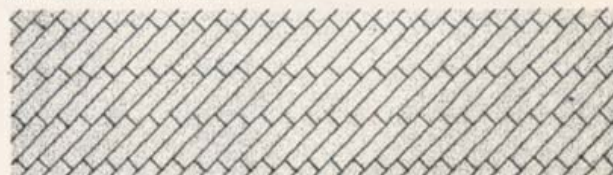
Klinker på kant, \frac{1}{2} -stens forbandt, 45^\circ
