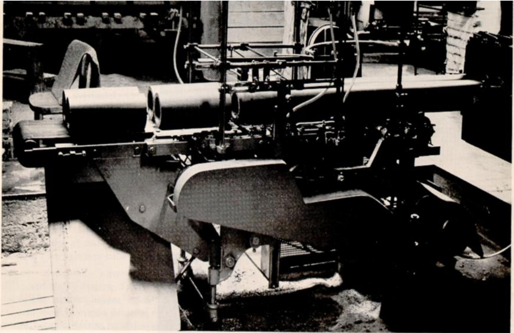
Strengpresning. De fleste teglværksprodukter formes dog på de såkaldte strengpresser. I princippet består strengpressen af en aksel med en snegl, der er indesluttet i en cylindrisk stålkappe. Fra indløbet presses leret, hvis vandindhold er mindre end ved hånd- og
