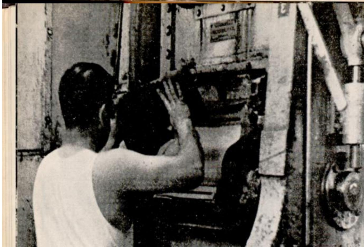
Tagstenspressen – den såkaldte revolverpresse – har to halvforme,
