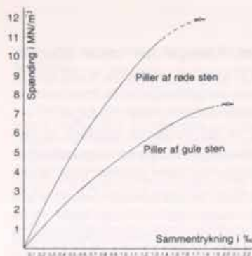
Arbejdslinier fra trykforsøg med 10 skifter høje, 1 · 1½ stens murværkspiller. Kurverne er middelkurver for to piller (I og II).
