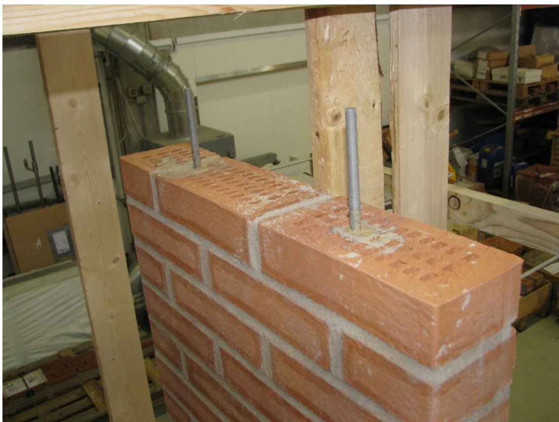
Figur 21.2. Forankring med Ø10 indlimede gevindstænger
