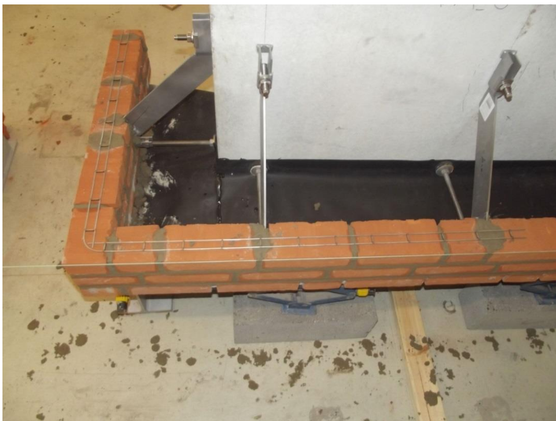
Figur 18.8. Armering i de overliggende skifter
