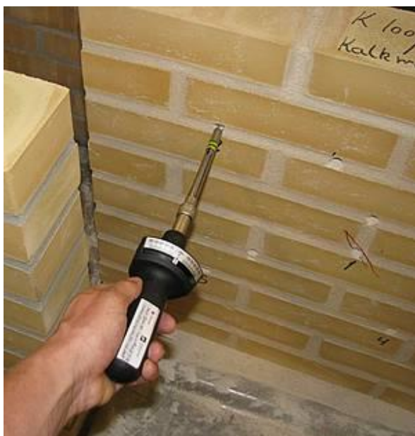
Figur 1. Bestemmelse af mørteltrykstyrken med X-bor
