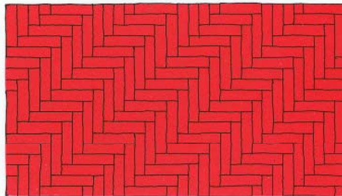
Sten på kant. Sildebensforbandt i kørselsretningen.
