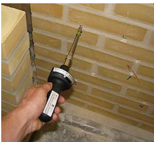
Fig. 15.3.4 X-bor til bestemmelse af mørtlens trykstyrke
