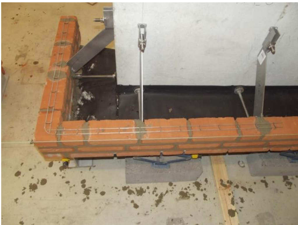
Figur 11.3.1. Armering til optagelse af bevægelser i hjørnet
