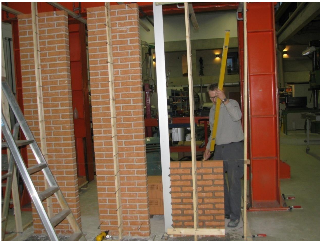
Foto 5. Bagmuren er færdigmuret og hærder af.
