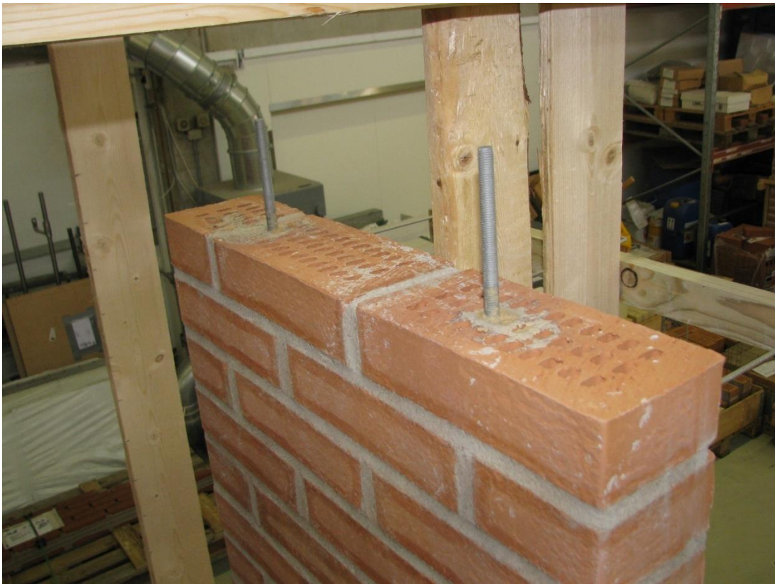
Foto 6. I top er indlimet 2 gevindstænger i de øverste 3 skifter. Mange forskellige løsninger kan anvendes ved forankring af toppen.
