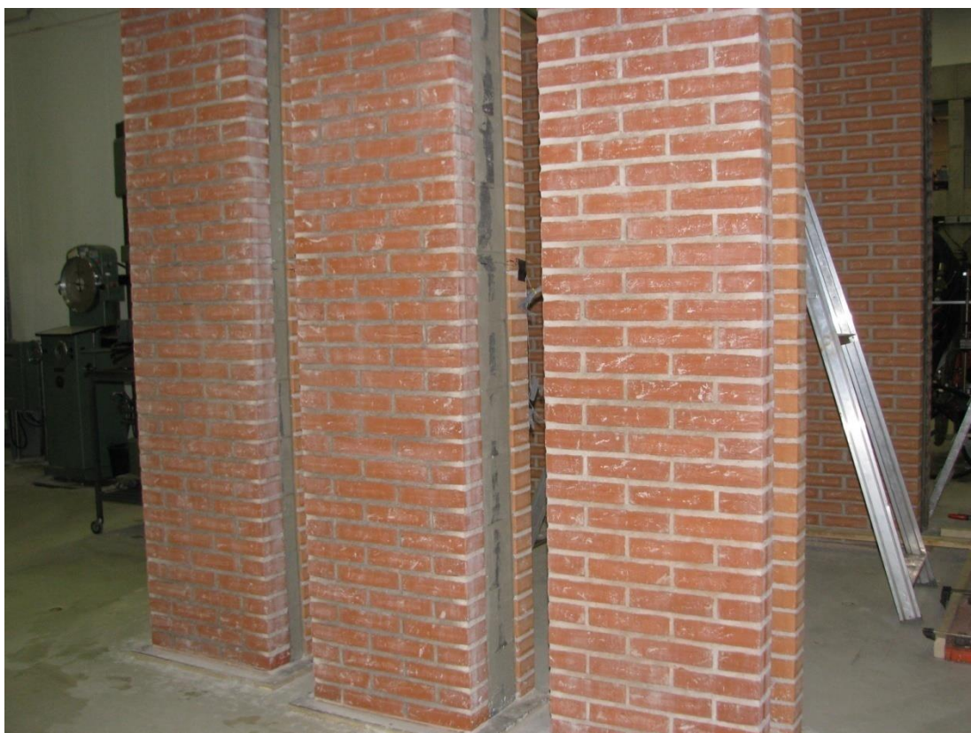
Foto 20. Bemærk formuren kan være længere tid om at hærde og tørre ud end normalt, da dette kun kan foregå fra 1 side mod normalt 2 (væg til højre er uden EPS).
