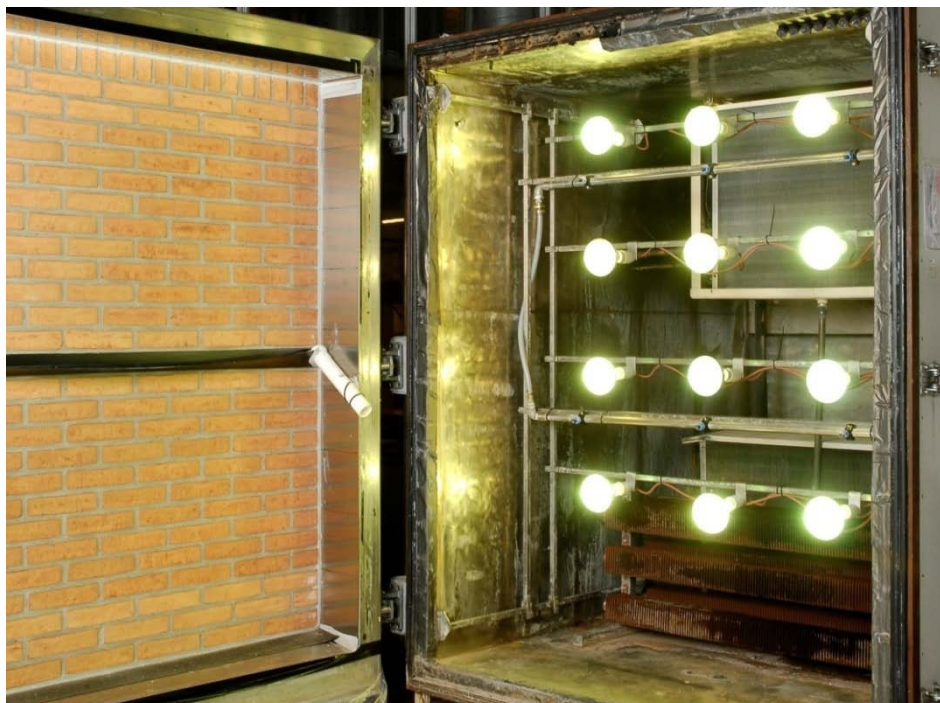
Figur 2. Forsøg B. Prøvemur til klimaskabsforsøg. Midt på muren sidder en TB-rende med et indbygget nedløbsrør i hver side (på billedet ses kun det i højre side).
