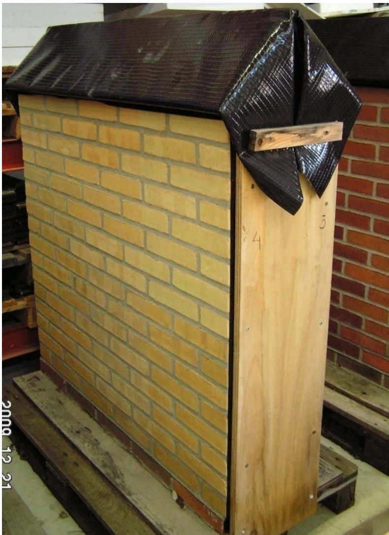
Figur 5. Forsøg A. Naturlig vejrligspåvirkning. Der konstrueres et tag til hver dobbeltmur, sådan at disse ikke vandbelastes unødigt.
