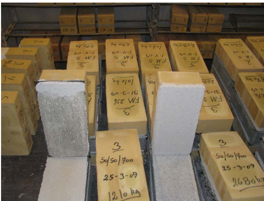
Foto 11. Brud i fuger uden pap og brud i fuger med pap. KC 50/50/700 tørmørtel og betonfundament
