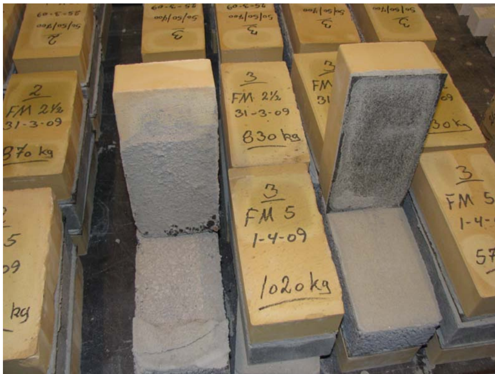
Foto 6. Brud i fuge uden pap og brud i fuge med pap. FM5 og letklinkerfundament
