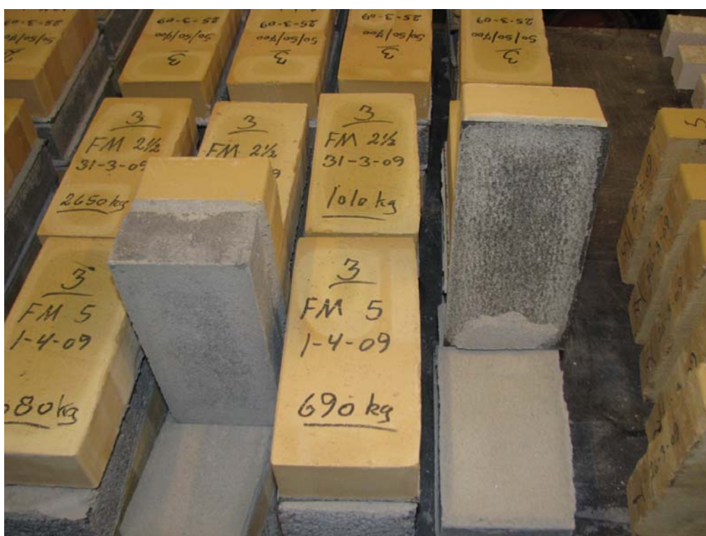
Foto 7. Brud i fuge uden pap og brud i fuge med pap. FM5 og betonfundament
