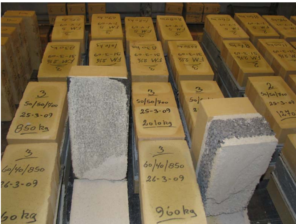
Foto 9. Brud i fuge uden pap og brud i fuge med pap. KC 60/40/850 vådmørtel og letklinkerfundament
