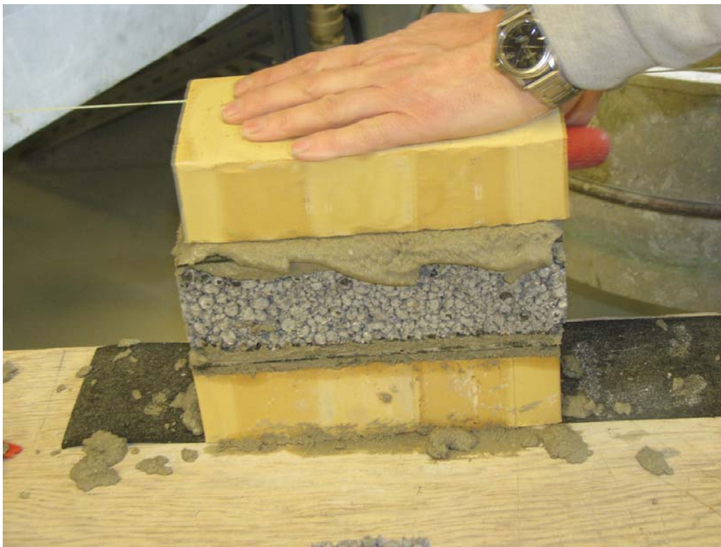
Foto 5. Sluttelig fås et tripple element, som beskrevet i EN 1052-3 og -4
