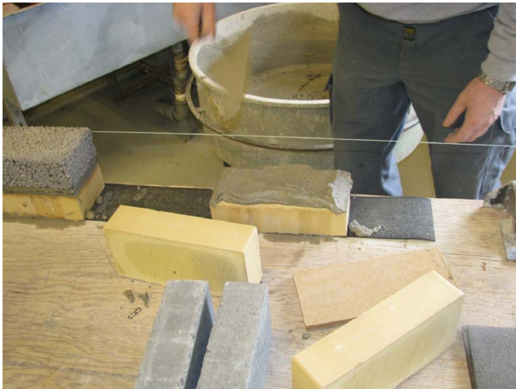
Foto 1. Mursten med mørtel svarende til cirka 6 mm fuger udlægges
