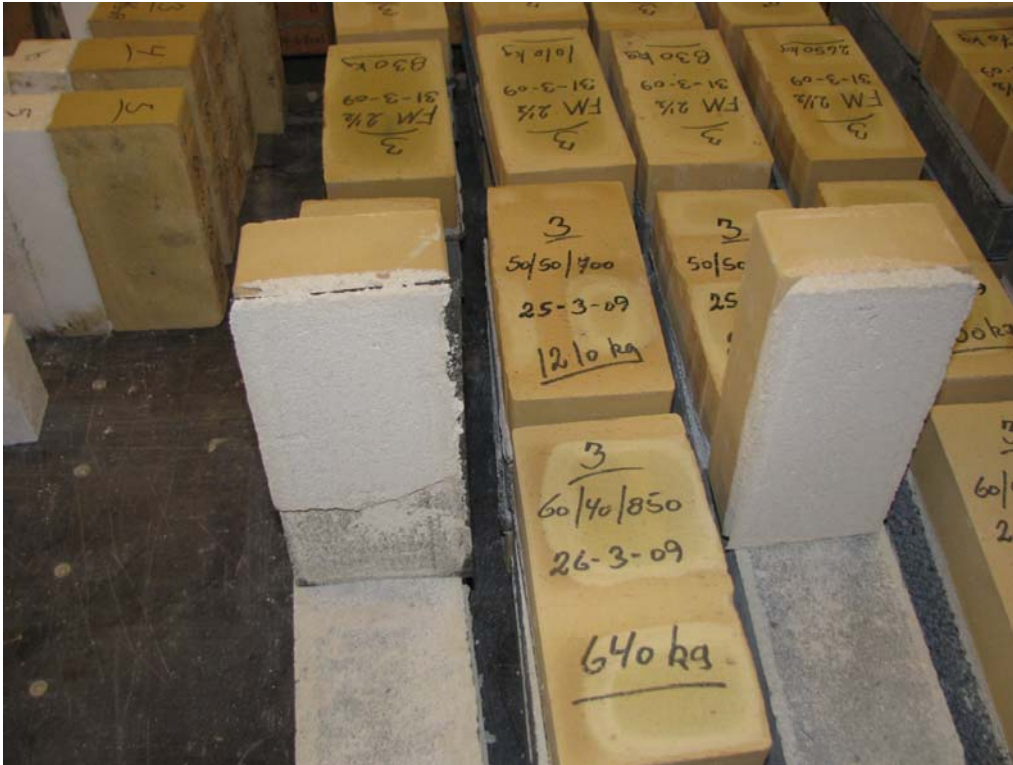
Foto 8. Brud i fuge uden pap og brud i fuge med pap. KC 60/40/850 vådmørtel og betonfundament
