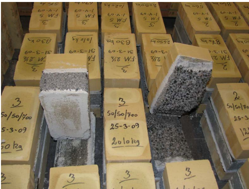
Foto 10. Brud i fuger uden pap og brud i fuger med pap. KC 50/50/700 tørmørtel og letklinkerfundament
