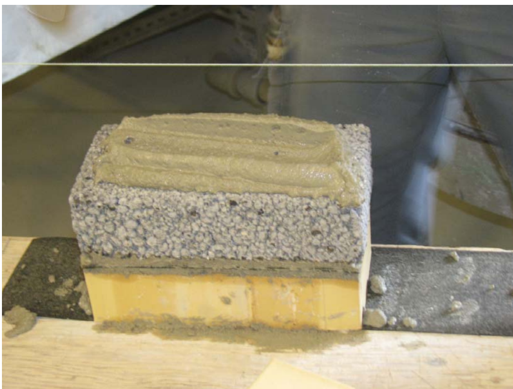
Foto 4. Sten repræsenterende fundament lægges og proceduren gentages på anden side af ”fundamentssten”
