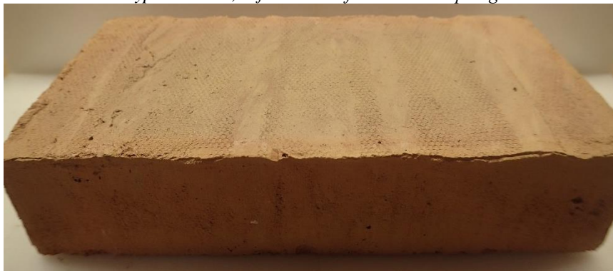
Picture 1. Brick type A: "Rosé, soft-molded" from Vedstårup Teglværk A/S
