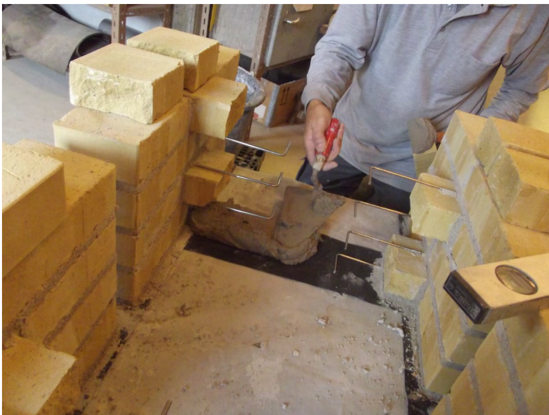
Foto 7. Prøvelegeme A. Stående fortanding m. bindere. Opmuring fortsættes efter ca. 1 uge
