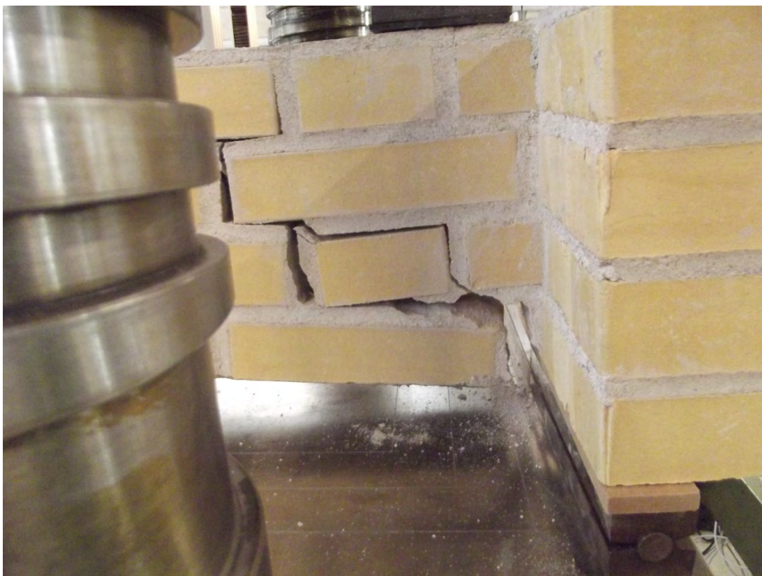
Foto 17. Forsøg Q. Alle brudformer var stort identiske, startende i studsfuge mod tværvæg og krav-lende opad
