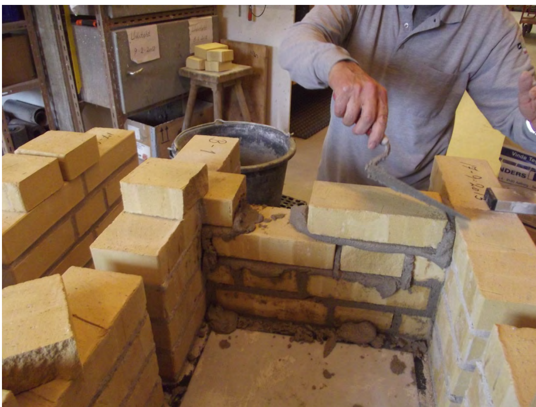
Foto 14. Prøvelegeme B. Stående fortanding u. bindere. Øverste skifte. Opmuring afsluttes
