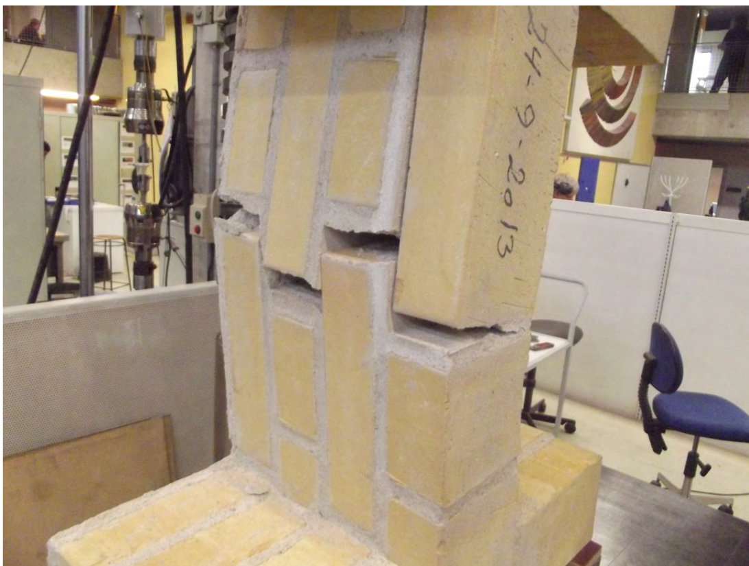
Foto 21. Brud M (A2). Brud uden for den stående fortanding
