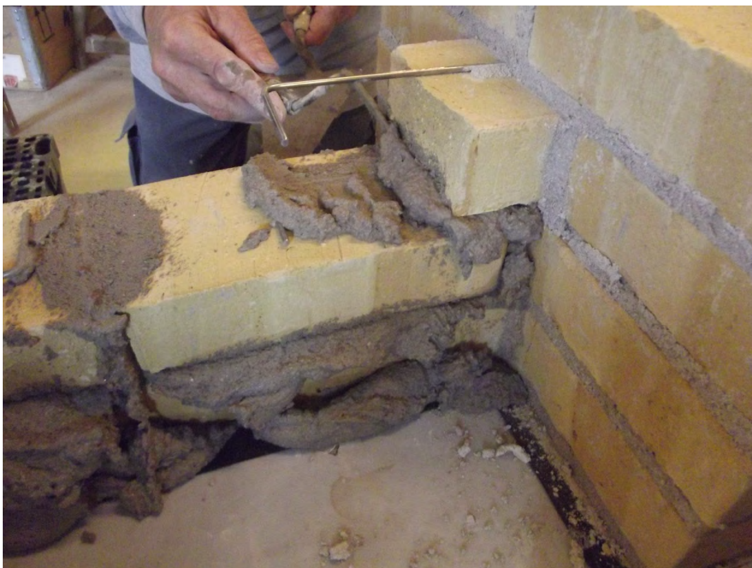
Foto 9. Prøvelegeme A. Stående fortanding m. bindere. Fugeske anvendes ved stående fortanding
