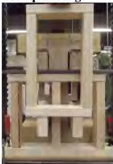
Billede 3. Forsøgsopstilling til trækprøvning
