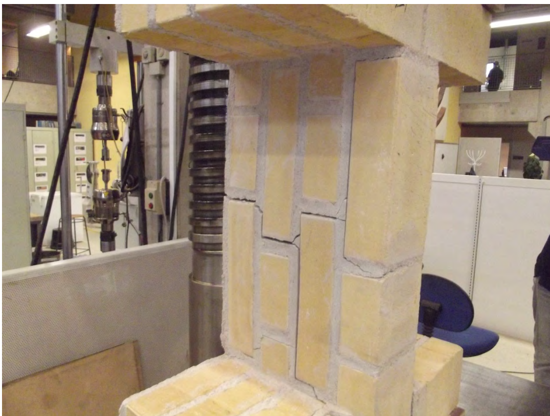
Foto 23. Brud M (C2). Brud i væg med liggende fortanding. Det ses, at bruddet sniger sig hen i området mod bagvæggen
