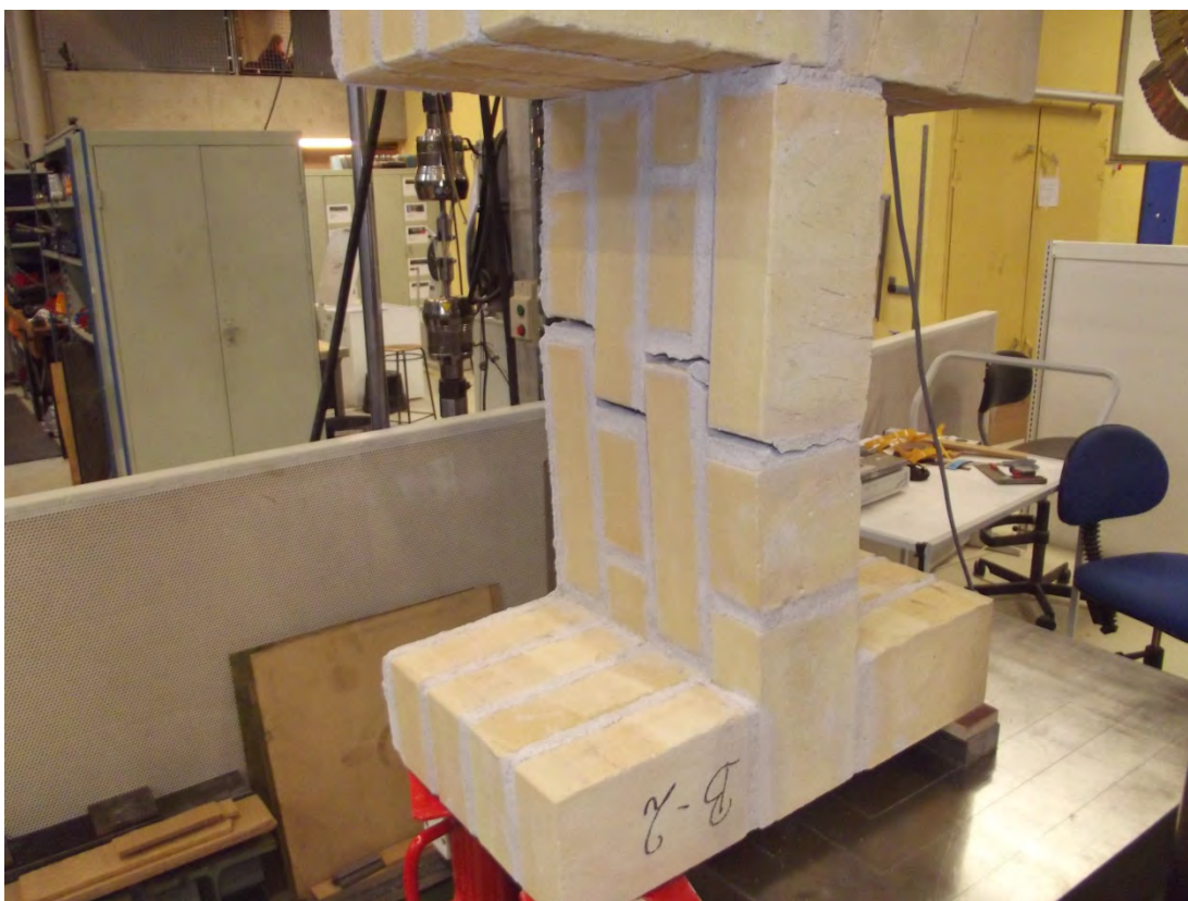
Foto 22. Brud M (B2). Brud uden for den stående fortanding
