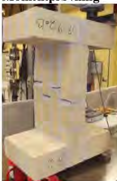
Billede 2. Forsøgsopstilling til momentprøvning
