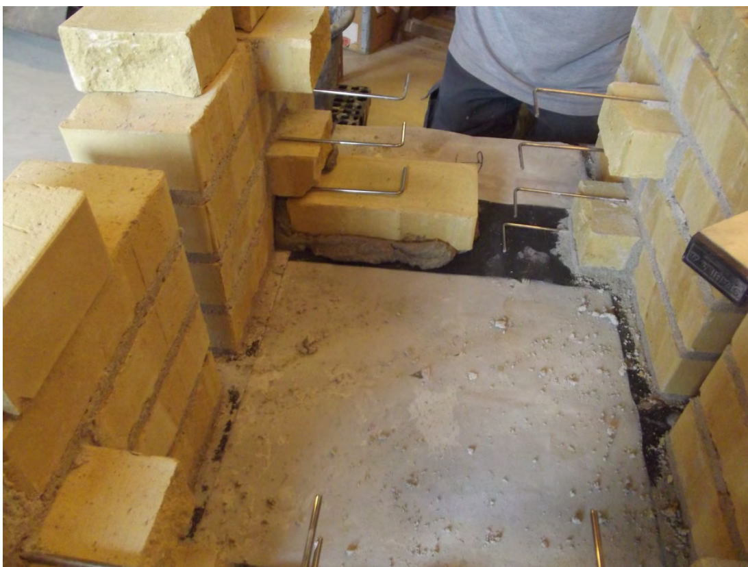
Foto 8. Prøvelegeme A. Stående fortanding m. bindere. Opmuring kompliceres lidt af at der skal mures „under binder“
