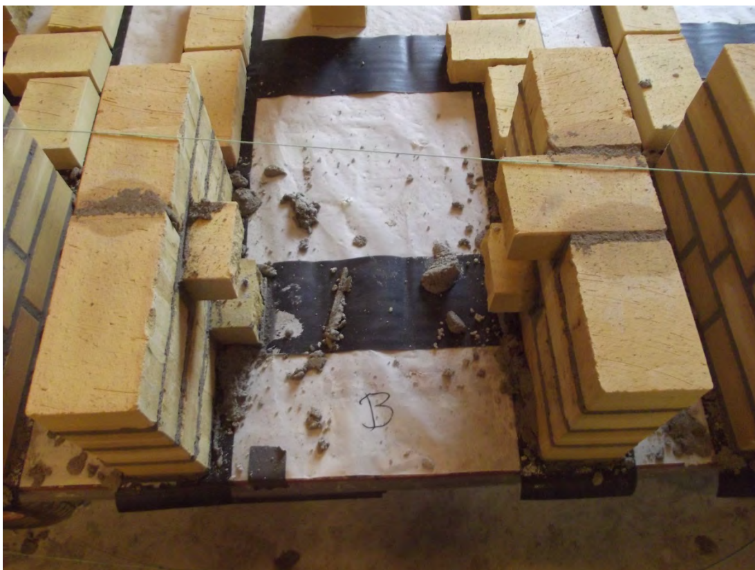
Foto 5. Prøvelegeme B. Stående fortanding u. bindere. Afventer videre opmuring
