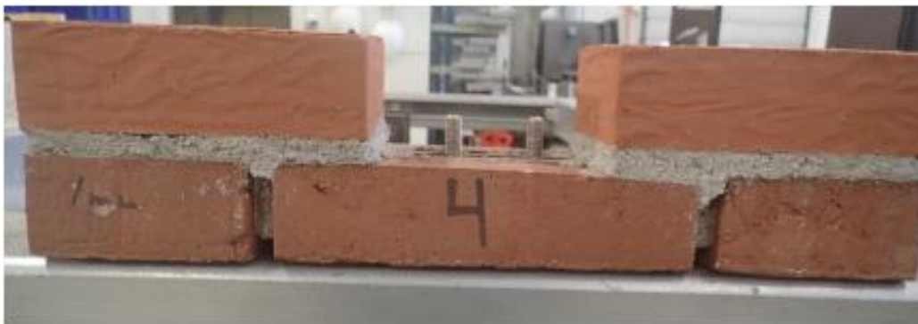
Figur 1: Eksempel på prøvelegeme. De to øverste sten er påmuret i forbindelse med forberedelse til prøvning, så elementet udgøres kun af det nederste skifte. Bemærk de 2 ankre i midten.
