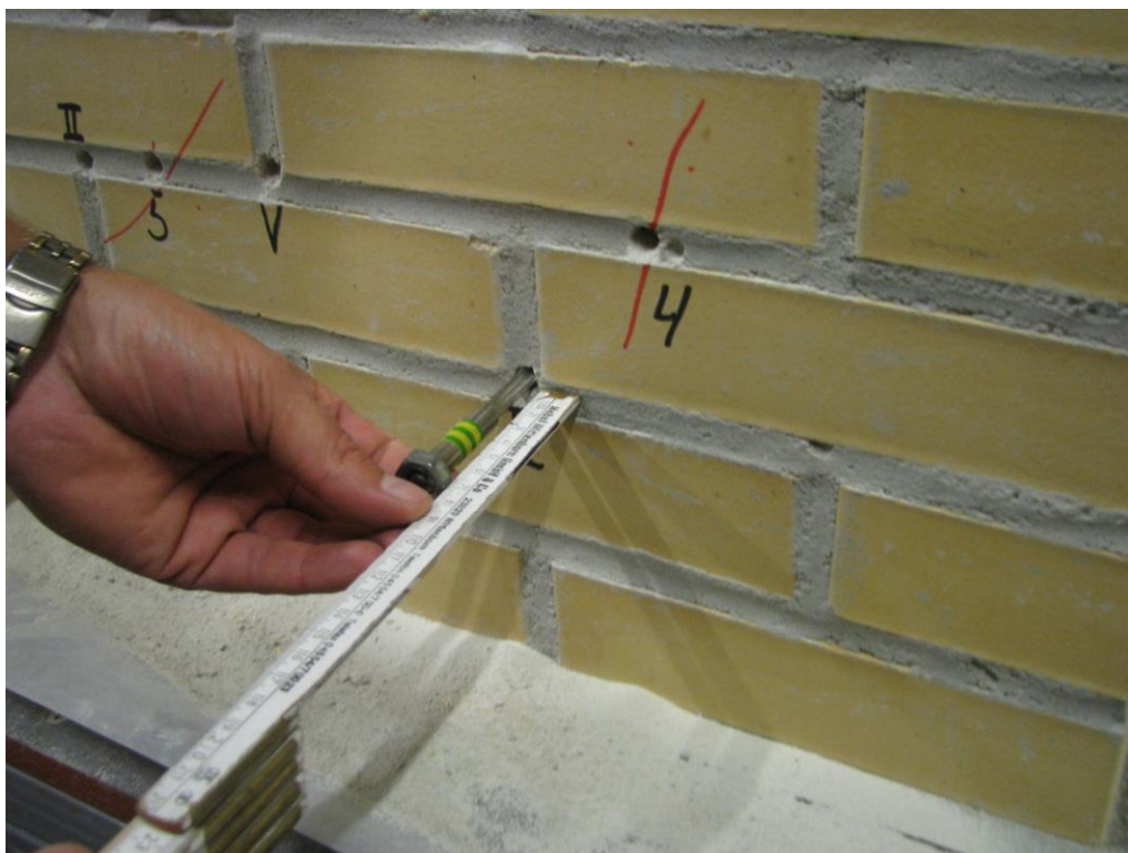
Figur 3. Bestemmelse af L_i . Afstand til møtrik måles før og efter indbankningen.
