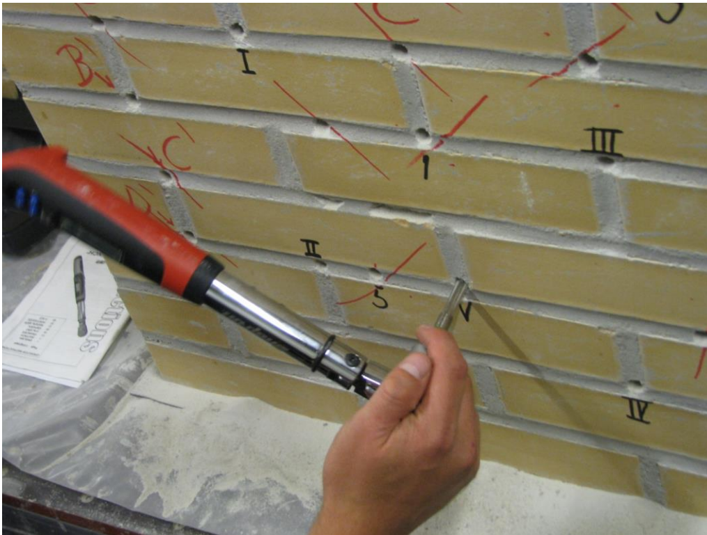
Figur 5. Momentnøgle med registrering af maksimal værdi anvendes til bestemmelse af M_v . Der holdes igen på krydsboret, således at den tilstræbte påvirkning alene er et vridende moment.
