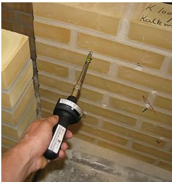
Figur B.1.3. Bestemmelse af mørteltrykstyrken med X-bor
