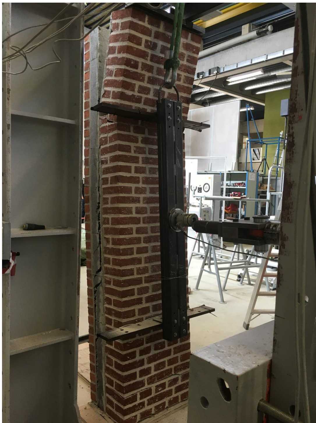
Foto 17. Herefter påføres vandret last i 4.-delspunkterne, indtil bruddet indtræffer.
