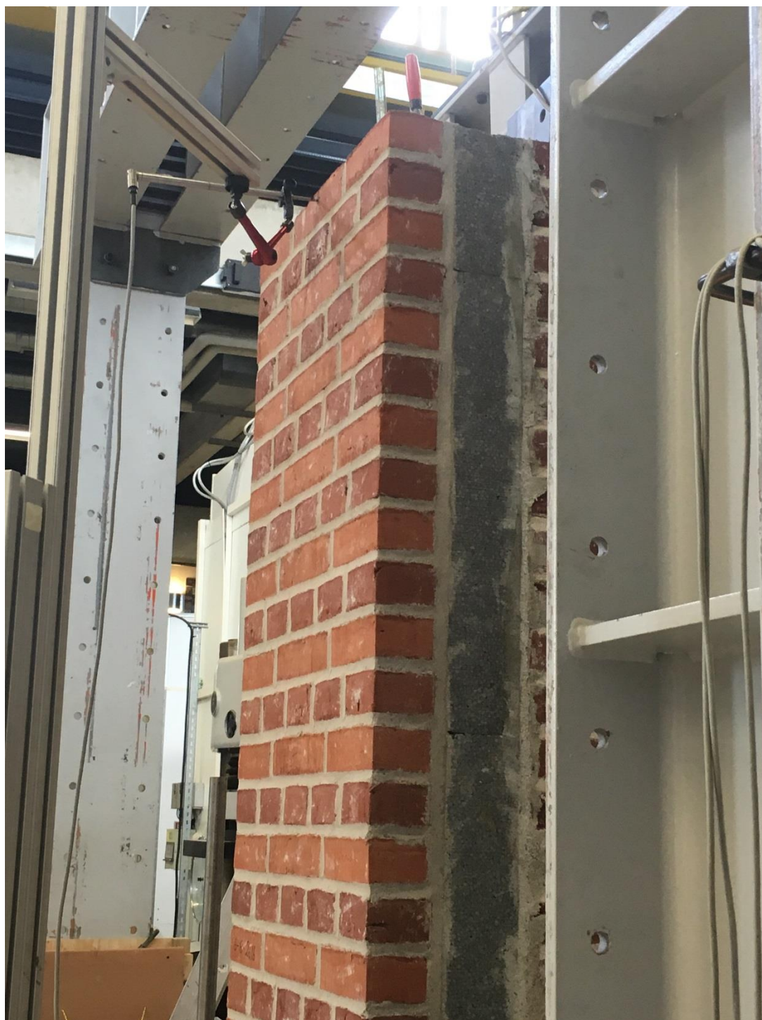
Foto 15. Slutresultatet af EPS-søjlen.
