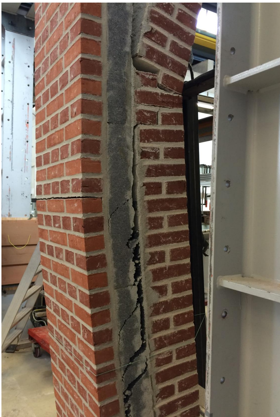
Foto 18. Kombineret forskydnings- og trækbrud i forskydningslaget.
