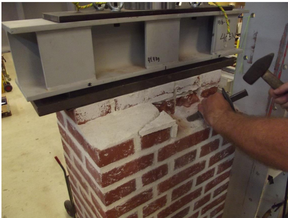
Foto 1. Afskrælning af væg med hammer og mejsel.
