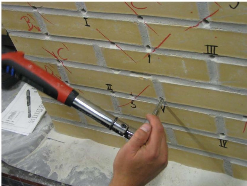
Figur 6. Momentnøgle med registrering af maksimal værdi anvendes til bestemmelse af M_v . Der holdes igen på krydsboret således at den tilstræbte påvirkning alene er et vridende moment.
