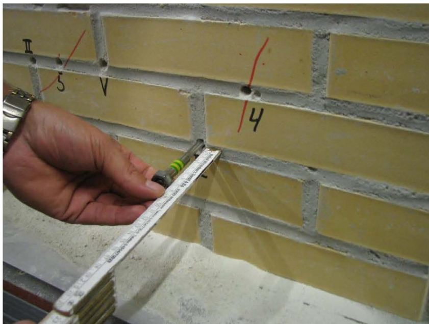
Figur 4. Bestemmelse af L_i . Afstand til møtrik måles før og efter indbankningen.
