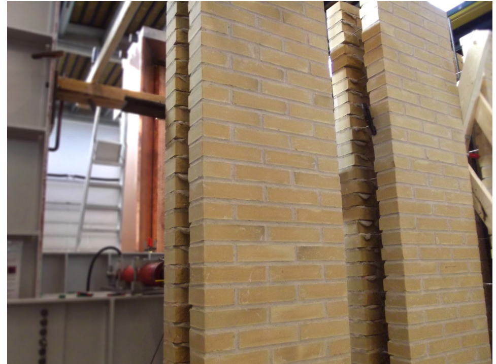
Figur 3. To vægge efter "brud" - begge vægge er udført med de nye bindere.
